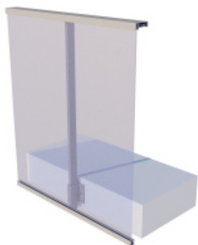
CONTRE DALLE AVEC PASSAGE DEVANT DALLE
