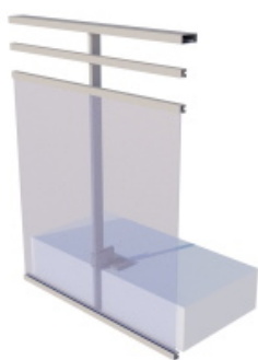
POSE SUR DALLE AVEC PASSAGE DEVANT DALLE
